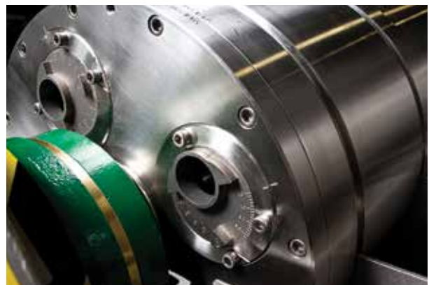
DE-1000 Effluent Ports
